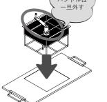
フライヤーの下に回収用ポットを置き、使用済み食用油(適正温度:80  $^{\circ}$   $^{\circ}$   $^{\circ}$  1  $^{\circ}$   $^{\circ}$  を回収し、 カス取りバットの中へゆっくり注いだら、上蓋をずらして専用再生剤を油溜容器の中へ投入します。 上蓋をリセットし、ハンドルをハンドルシャフトにセットして時計回りにゆっくり回します。 約2分間回し続け、回し終えたら20分以上放置させます。
