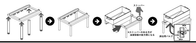
目皿器の両側に畳んである取っ手を立ち上げ、油溜容器の中へ入れます。 その後に専用フィルターを被せて、フィルターの端を外側へ折り返したら、上蓋を載せます。
